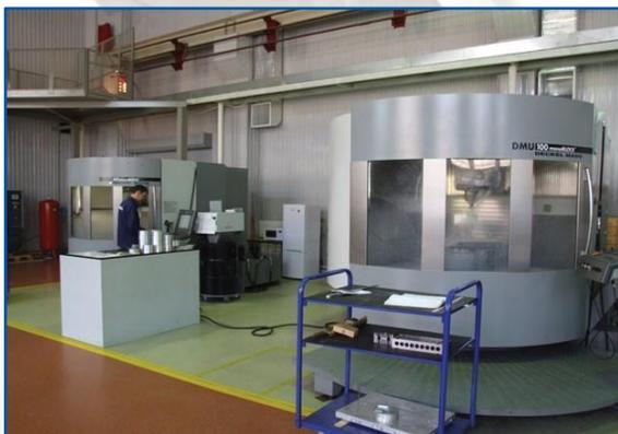
*Фрезерные ОЦ DMU 60, DMU 100*
