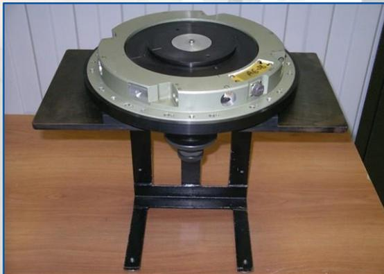
Блоки датчиков положения ротора регулируются и настраиваются на специальном аттестованном стенде-калибраторе вместе с поставляемыми с ними в комплекте согласующими трансформаторами, сигнальными кабелями и блоками управления.
