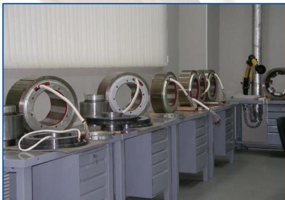
*Участок монтажа и сборки электромагнитов*
