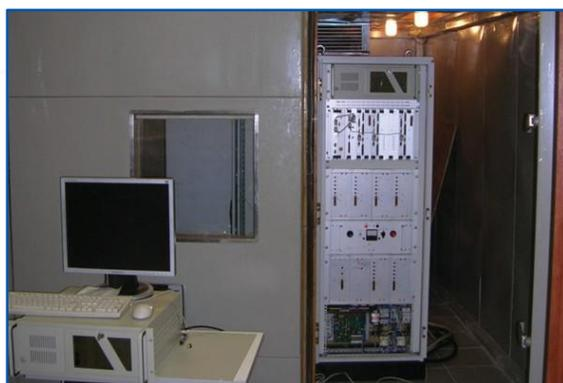
*Тренировка блока управления в термокамере*
