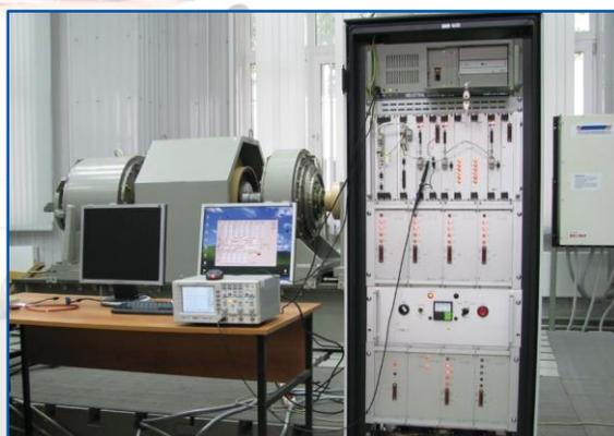
*Испытания блока управления в составе динамического стенда*
