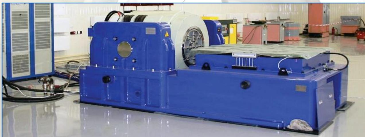
*Стенд для испытаний на механические воздействия*
