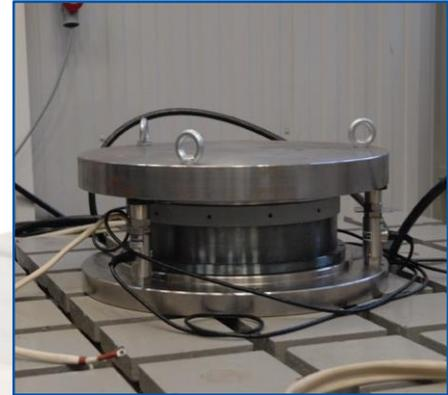
*Стенды для проверки грузоподъемности радиальных и осевых электромагнитов*
