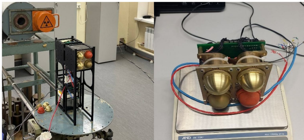
Детектор ГАМВЭКИ-ГМ на калибровке во ВНИИМ им. Д. И. Менделеева
