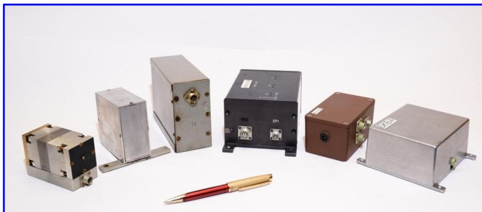
**Рис. 1. Линейка спутниковых акселерометров, разработанных в ИФЗ РАН**
