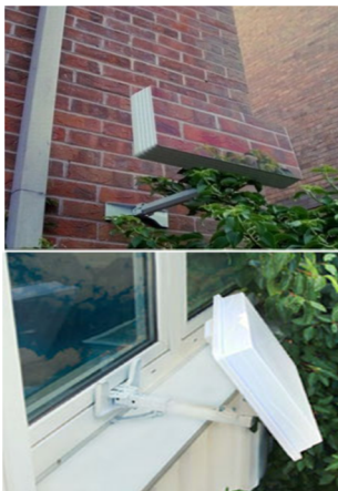
Рис. 1. Микрополосковые приемные антенные решетки спутникового телевидения, работающие в диапазоне 10,70 – 12,75 ГГц
