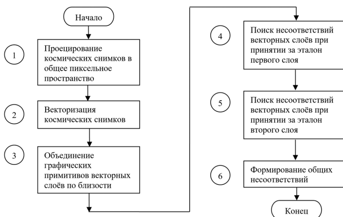
Рис. 1. Блок-схема этапов тематической обработки космических снимков для задачи мониторинга местности
