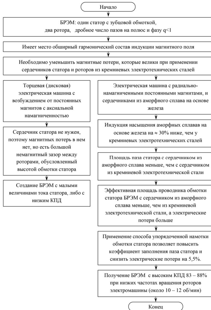
Схема алгоритма выбора технических решений при проектировании БРЭМ
