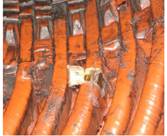
д) ЭГПА4 Ямбург-Елец-2 КС «Помары»; е) ЭГПА7 Уренгой-Центр-2 КС «Починки»; Рис. 4.2. Фотографии повреждений статоров приводных электродвигателей СТД.
