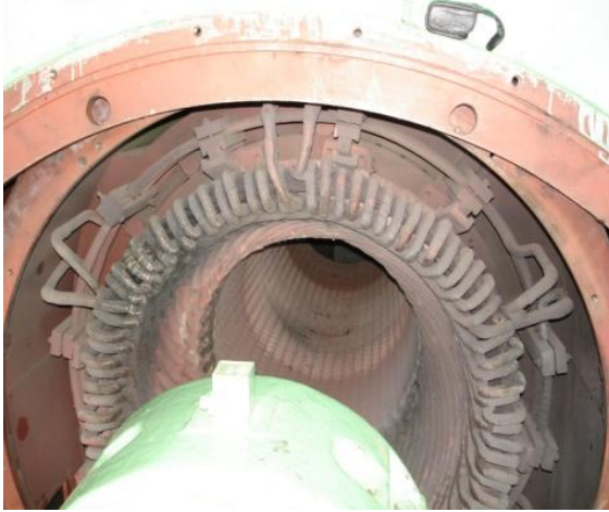
д) ЭГПА4 Ямбург-Елец-2 КС «Помары»; е) ЭГПА7 Уренгой-Центр-2 КС «Починки»; Рис. 4.2. Фотографии повреждений статоров приводных электродвигателей СТД.
