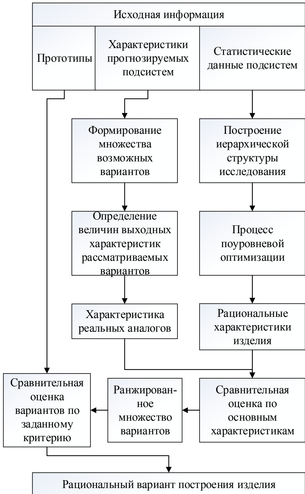
Рисунок 1-7 Схема процесса выбора рационального построения изделия [24]
