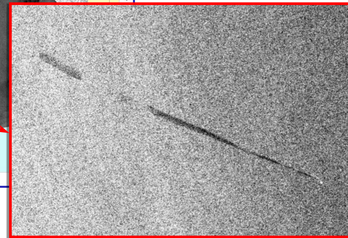
Длина шлейфа нефтяного загрязнения 45,7 км
